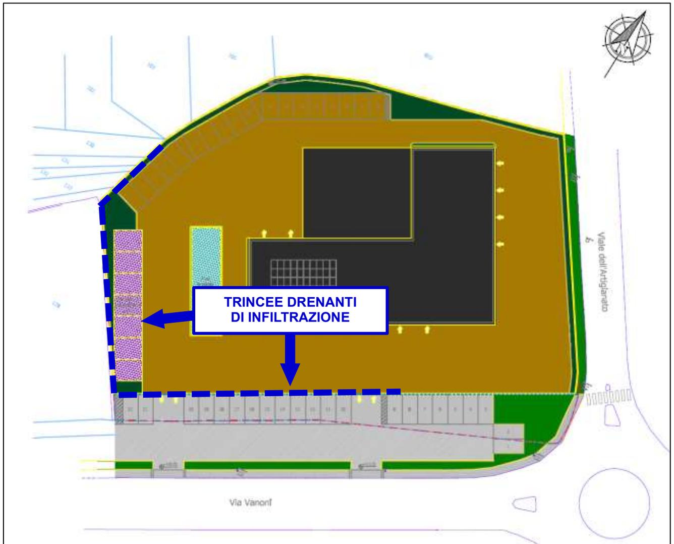
Fig. 12 – Stralcio elaborato progettuale con ubicazione IN VIA PRELIMINARE delle trincee drenanti di infiltrazione
