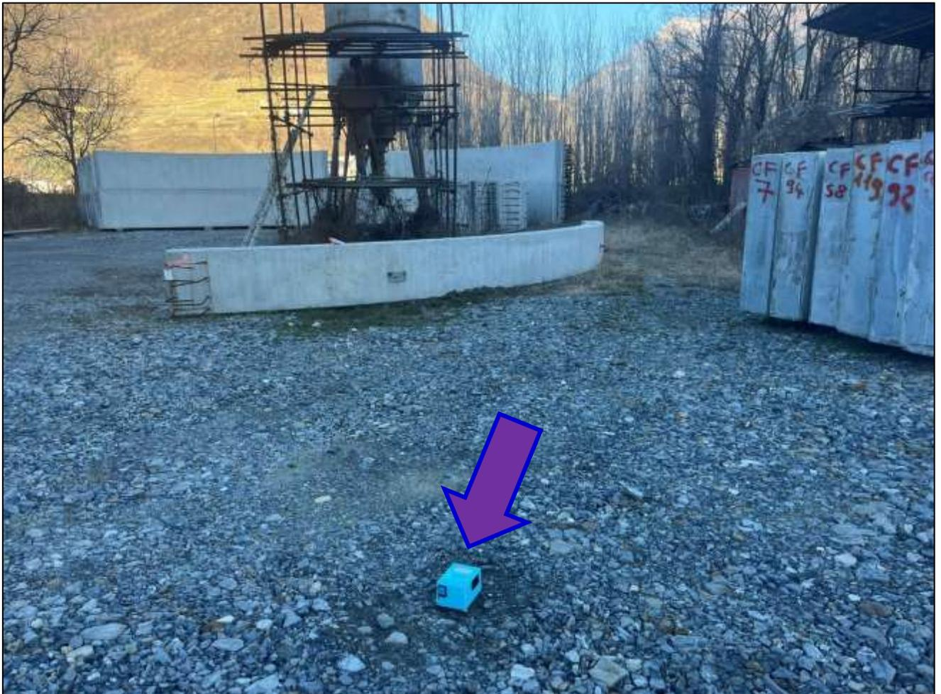
Fig. 11 – Punto di esecuzione indagine di sismica passiva HVSR con strumentazione TROMINO ®
