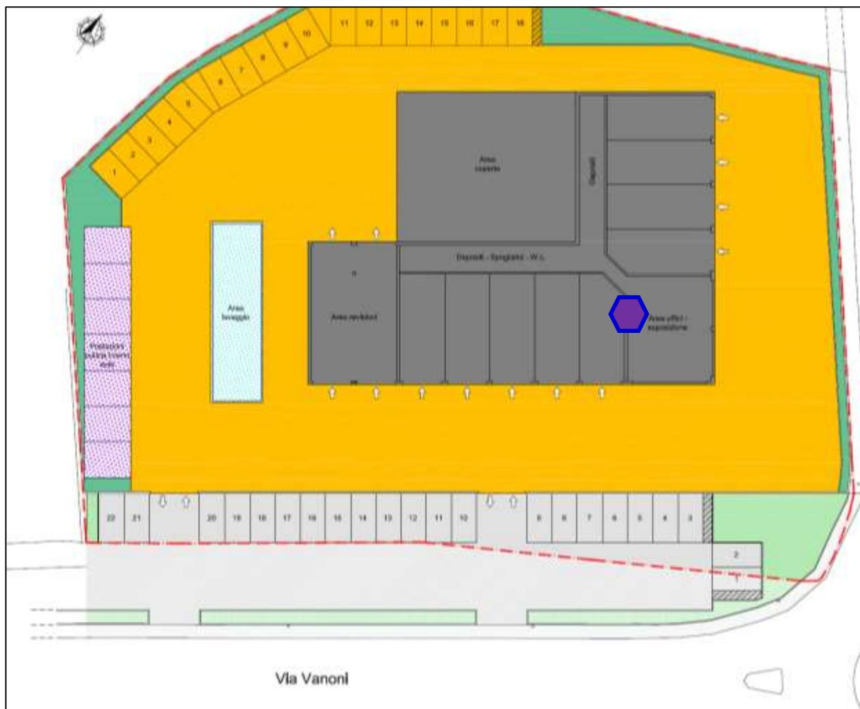
Fig. 10 – Stralcio tavola "Planimetria generale" con ubicazione punto di esecuzione indagine di sismica passiva HVSR con strumentazione TROMINO ® (esagono viola)
